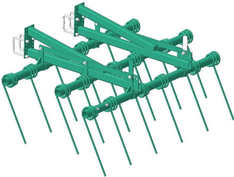
Рисунок 7 – ПБП - трёхрядная пружинная борона
