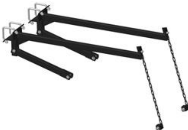
Рисунок 10 – ПБЗ - приспособление для навески зубовых борон
